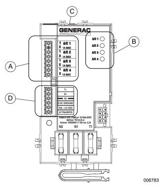
Figure 2-2. Smart A/C Module (SACM)
